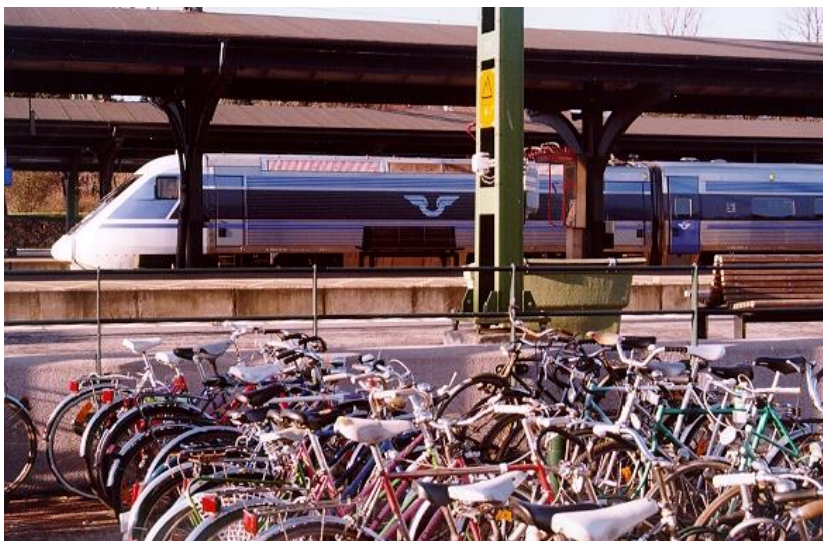
Figur 5-15 Närhet är den absolut viktigaste faktorn när man planerar cykelparkering. Här cykelparkering längs perrongen vid Lund C. Gångavstånd till perrong/nedgång till perronger inom 10-50 m.
